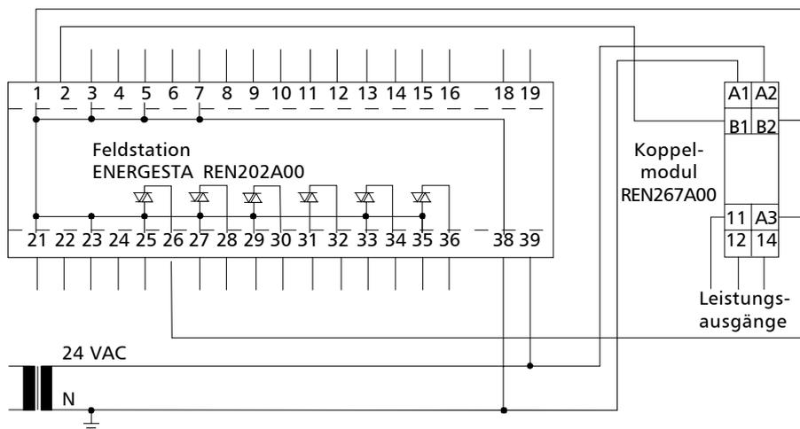
**Achtung:** Bei REN Triac-Ausgängen wird nach N geschaltet! Daher muss A2 an 24 VAC gelegt werden.
