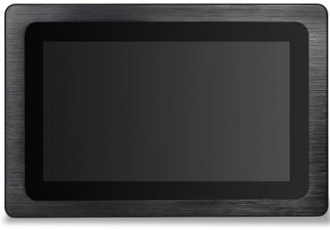
Controlesta RCO 686D-S ist eine grafische 10,1" Touch-Bedienstation für das Gebäudeautomationssystem Controlesta RCO. Die Bedienstation nutzt die embedded Webserver-Funktionalität der Controller Serie RCO 8...D-W, RCO 9...D-Wund greift über das Netzwerk zu. Eskönnen animierte Anlagenbilder visualisiert werden, Sollwerte, Zeitpläne, etc. verändert werden, online und historische Trends grafisch dargestellt werden sowie Alarme angezeigt und quittiert werden.
